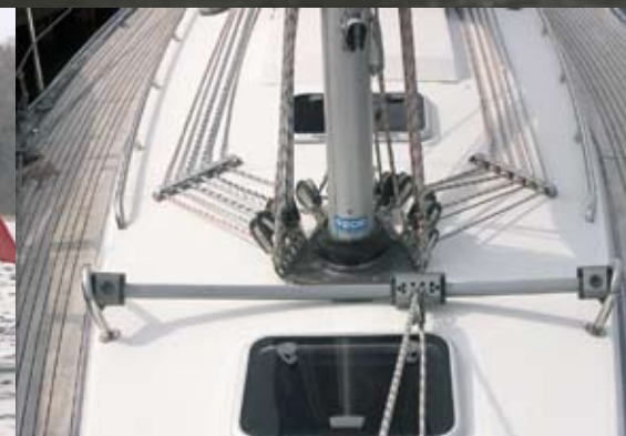
Alle bal og liner er ført tilbage til cockpittet. Den selvslående fok gør båden nem at håndtere.
