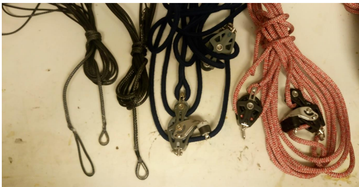
Fr. v. akterstag för Neptunkryssare i 4 mm dyneema, backstag i 5 mm dyneema, kicktalja och backstagstalja i 8 mm flätad polyester.
